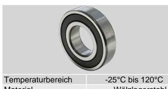
Material Wälzlagerstahl 100Cr6 Dichtungsart 2RS - beidseitig schleifend (Kunststoff) D (mm) 52 20 d (mm) C0 - Normal Lagerluft B (mm) 15 Marke: SKF
